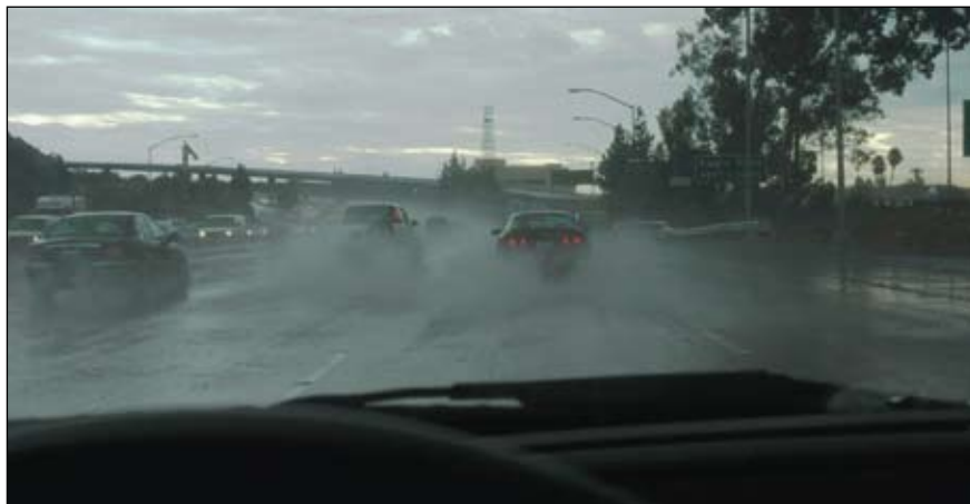
Рис. 7. На скоростном шоссе в южной Калифорнии во время дождя: Дожди здесь бывают 20 дней в году, а снега не бывает вовсе. Продольные бороздки существенно улучшают трение в контакте колеса и покрытия, однако вода разбрызгивается из-под колес, что сильно ухудшает видимость. Поэтому вместо обычных 110–130 км/час водители во время дождя снижают скорость до максимум 40–50 км/час.
